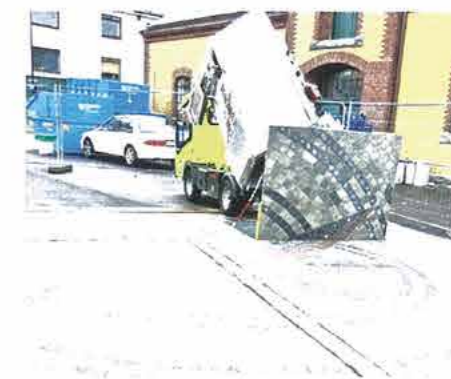
Die Anlage in Norwegen wird als Zwischenlager genutzt. Kleinere Reinigungsfahrzeuge entleeren den gesammelten Abfall in den Quadromaten. Sobald dieser voll ist, wird der Müll abtransportiert. Der Vorteil: Die Fahrten werden markant minimiert, die Abfuhr wird effizienter und kostengünstiger. Dazu ist es die optimale Lösung für Städte mit engen Straßen, in denen große Fahrzeuge Probleme haben.
